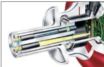
すべての測定構成要素はCOREオプティックス・モジュールとして一体化されています。特許のCOREオプティックスは外力や振動の影響から隔離されています。COREオプティックスは機械的調整箇所を含んでいません。
