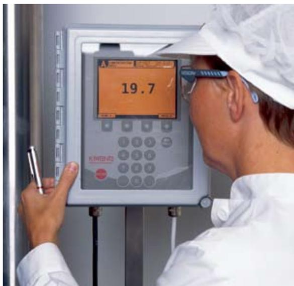
K-PATENTS PR-23-A型 サニタリプロセス屈折率計
